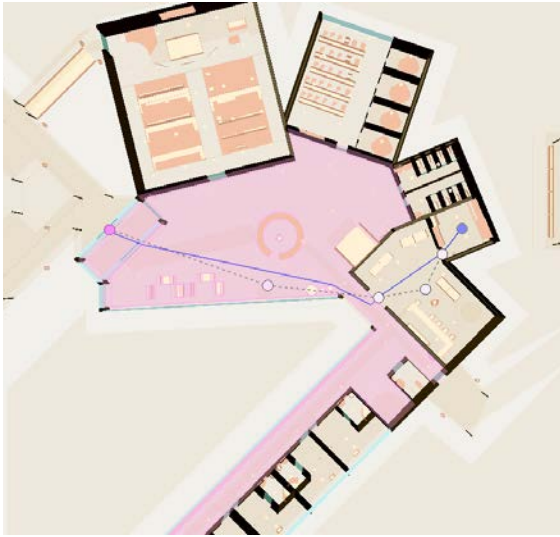
5 Grundrissdarstellung eines Pfades vom Eingang (links) durch den zentralen Hauptraum (rosa Bereich) zum Restaurant.
