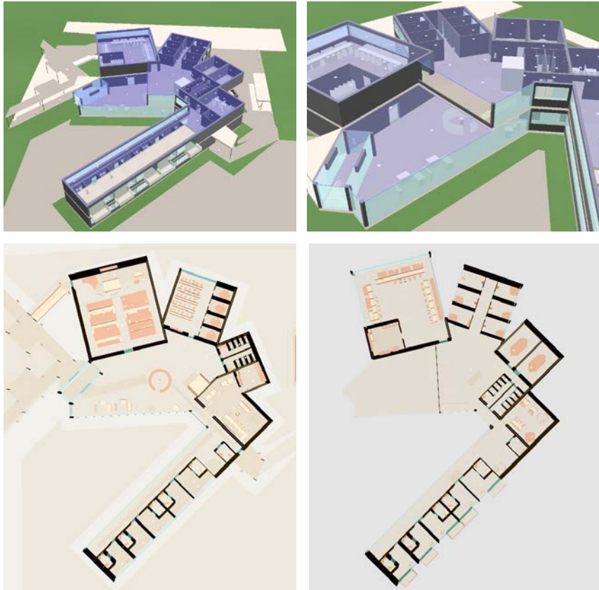
3 Eine über DSim dargestellte Analyse des Entwurfs a–b) in einer 3D-Wiedergabe des Gebäudes sowie in einer 2D-Wiedergabe des Grundrissplans; c) vom Erdgeschoss; d) vom ersten Stock.
